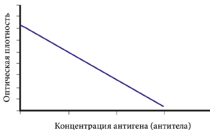
Рис. 66. Калибровочный график зависимости уровня регистрируемого сигнала от концентрации анализируемого вещества для определения оставшихся свободных центров специфического связывания (по [26]).
