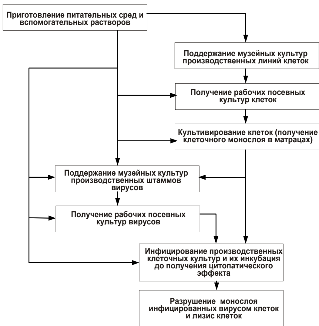
Рис. 114. Общая технологическая схема получения нативных вирусных антигенов (вирусных лизатов)
