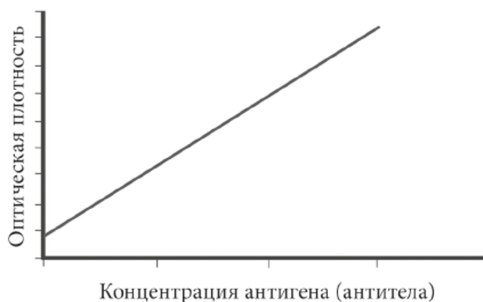
Рис. 57. Калибровочный график зависимости уровня регистрируемого сигнала от концентрации анализируемого вещества (по [26]).
