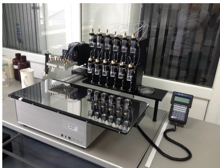
Рис. 122. Машина фирмы BioDot для нанесения полос антигенов на мембрану
